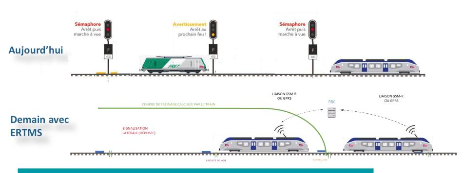
Demain : l'espacement est réduit car adapté à la capacité de freinage de chaque train > Permet de tirer le meilleur parti du réseau
