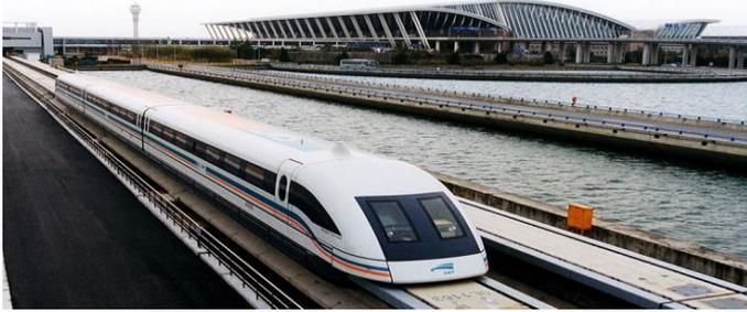
Le principe : le train se déplace **en lévitation** limitant ainsi les frottements grâce à des électro-aimants assurant également le guidage et la propulsion.
