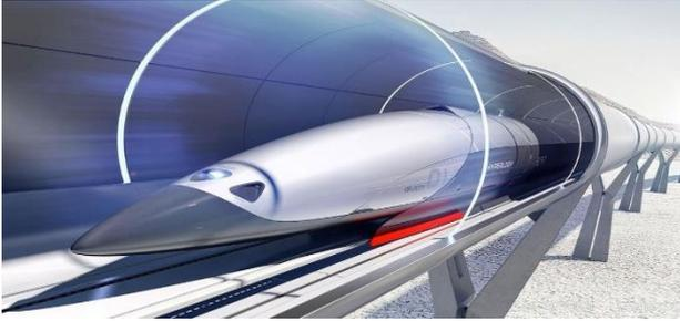
Le principe : **tube à basse pression** limitant ainsi les frottements aérodynamiques dans lequel se déplacent des capsules transportant des voyageurs et/ou des marchandises.
