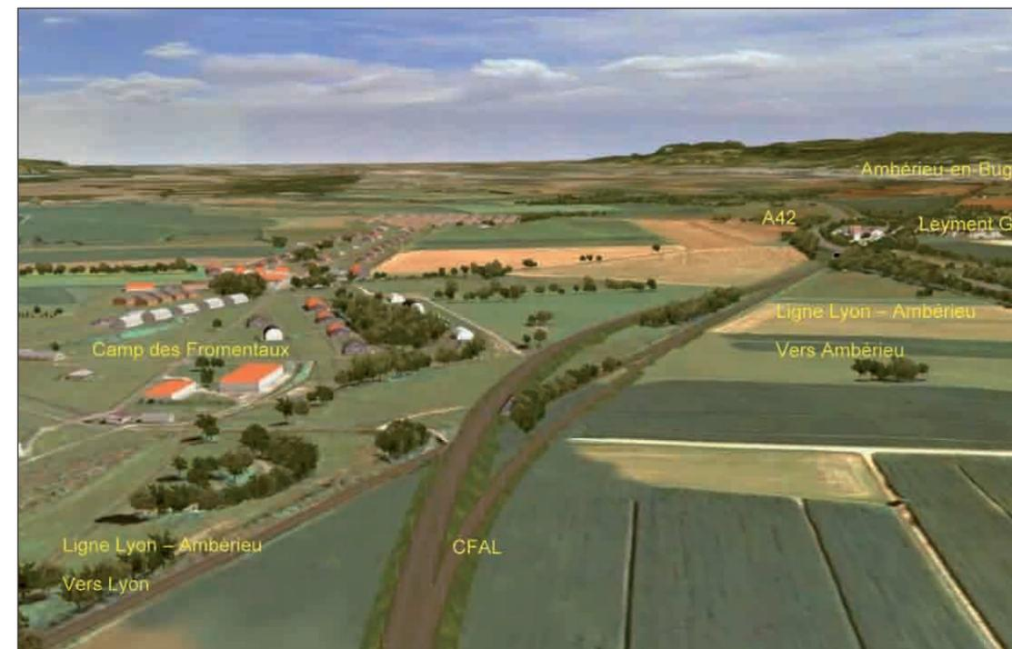
PRINCIPE DE RACCORDEMENT SUR LA LIGNE LYON - AMBÉRIEU-EN-BUGEY À LEYMENT.
