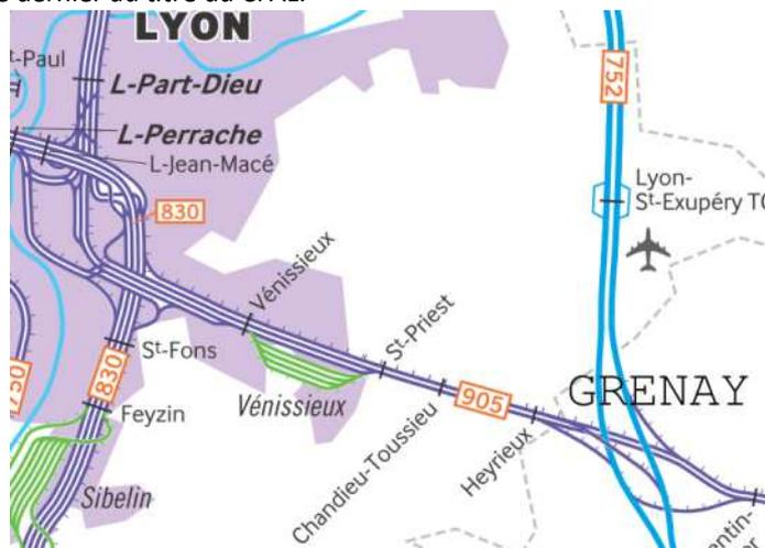
La ligne est déjà à quatre voies de St Fons jusqu'à l'ouest de la gare de Vénissieux. De Vénissieux aux abords de la gare de St Priest, la ligne actuellement à 3 voies est complétée par une quatrième voie implantée côté sud. Au-delà de la gare de St Priest jusqu'au raccordement LGV de Grenay, il faut ajouter deux voies nouvelles aux deux voies existantes.
