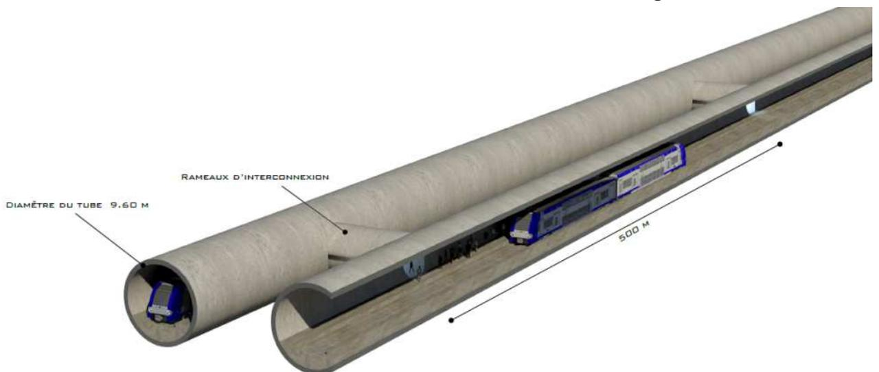
En comparaison à un ouvrage monotube, un ouvrage bitube permet de de démarrer le creusement au tunnelier avec une épaisseur de terrain plus faible, ce qui limite les longueurs de tranchées à réaliser. Il nécessite en revanche plus de largeur au point de démarrage du creusement pour loger les têtes de chaque ouvrage. Pour un bitube, il est également possible de réaliser deux sorties distinctes, une pour chaque ouvrage.
