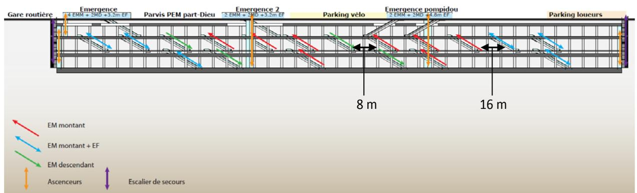
Figure 23 : Problématique d'organisation des escalators dans une configuration symétrique
