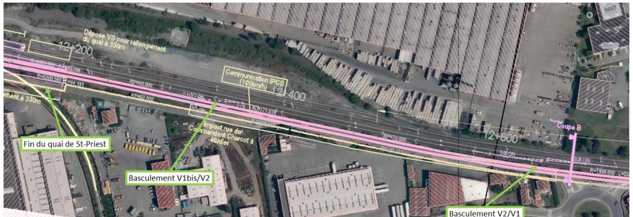
*Insertion des communications V1bis/V2 et V2/V1 à l'est de la halte de St-Priest*
