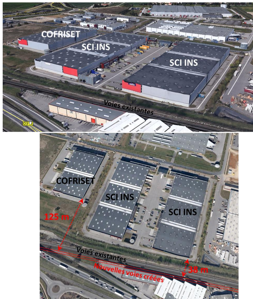
Figure 14 : Positionnement des nouvelles voies à créer au droit de la ZPR de la ZAC des lumières, Source Google Earth et Egis
