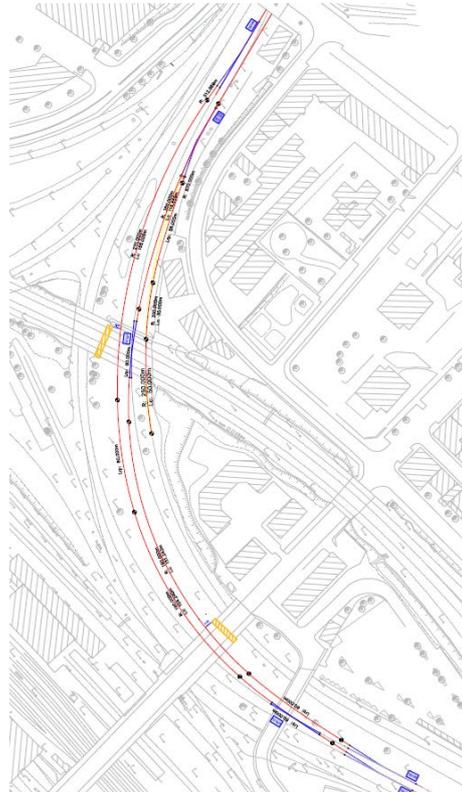
A noter que ce tracé a pour effet de ramener une contrainte de gabarit sur les voies souterraines dans la représentation proposée : la contrainte de gabarit revient de 50m vers les sauts de mouton → la longueur réellement disponible devient alors 200m entre l'amorce de la rampe, et le point de passage sous les voies 1 et 2 Part Dieu futures ; soit une pente non corrigée (mini) de l'ordre de 35%.
