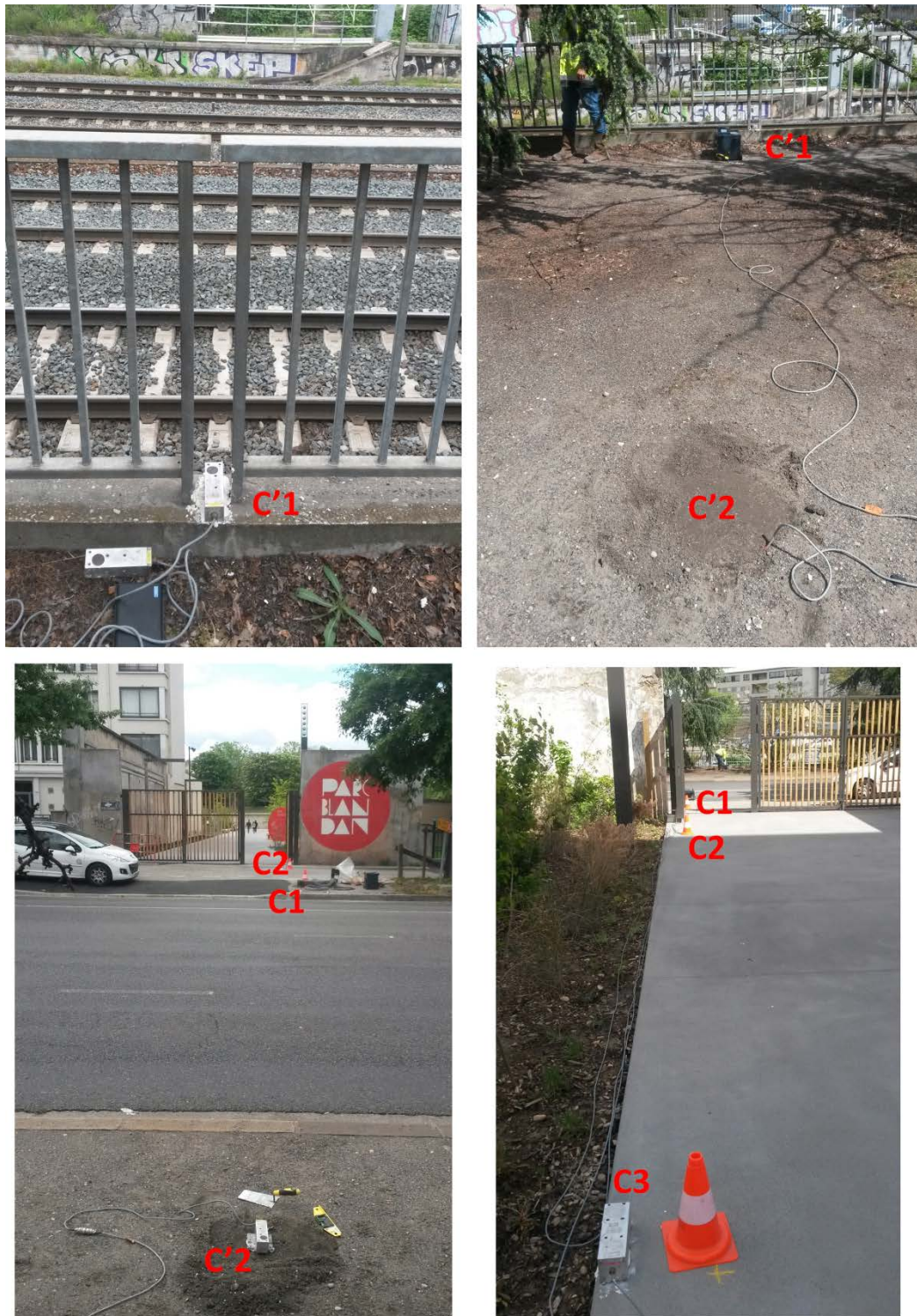
Figure 17: emplacement des capteurs - Boulevard des Tchecoslovaques
